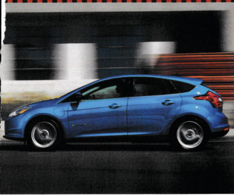
FORD FOCUS ELECTRIC Sein Elektromotor verfügt über eine Leistung von 145 PS. Um den Stromverbrauch in Grenzen zu halten, ist die Spitze auf 137 km/h limitiert. Dank Rückgewinnung der Bremsenergie schafft der reine Stromer bis 220 Kilometer Reichweite. Vier Stunden Ladezeit an der Powerstation ergeben wieder 80 Kilometer. Preise: ab CHF 36 600.-.
