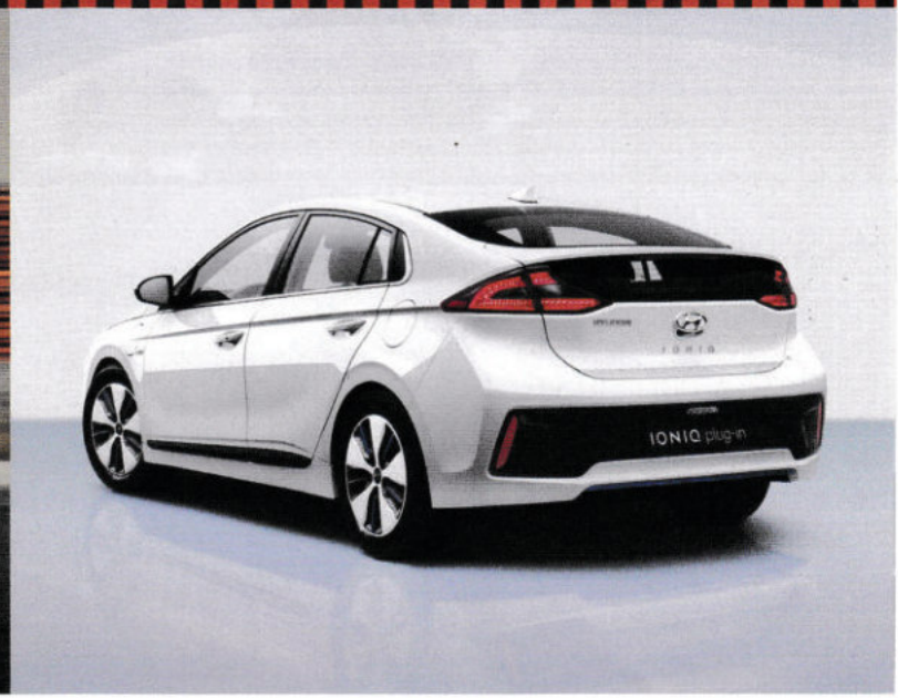
HYUNDAI IONIQ PLUG-IN-HYBRID Ein Wurf der Koreaner. Im Idealfall liegen 63 Kilometer rein elektrisch drin. Im kombinierten Modus beträgt die Reichweite über 1000 Kilometer, bei einem Verbrauch von 1,1 Liter Benzin pro 100 Kilometer. Dazu kommt der Stromverbrauch von 9,4 Kilowattstunden pro 100 Kilometer. Preise: ab CHF 40 790.-.
